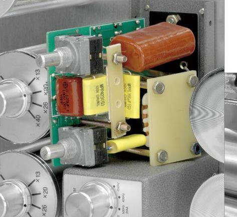
Links und unten: Die passive RIAA-Entzerrung erfolgt über ein LCR-Netzwerk (L = Induktivität der Spule/C = Kapazität des Kondensators/R = Widerstand) und weist eine Besonderheit auf: Der Kondensator liegt nicht im Signalweg, sondern wird parallelgeschaltet. Die Schaltungsdesigns Kang Su Parks schließen immer auch eine sehr strenge Bauteileselektion ein
