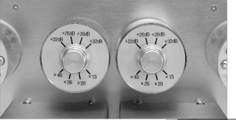
Links und unten: Die Primärwicklung der Übertrager wird direkt oberhalb der dreifach geschirmten Übertrager abgegriffen. Auf diese Weise wird das Übersetzungsverhältnis eingestellt. Auch die beiden Multi-Curve-LCR-Einheiten sind einfach von oben zugänglich
