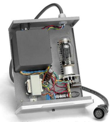
Die Röhrengleichrichtung im externen Netzteil übernimmt eine kräftige 5AR4-Röhre aus russischem Militärbestand. Die räumliche Trennung von Elektronik und Stromversorgung erlaubt den Einsatz eines besonders starken Transformators. Ein Einfluss durch Magnetismus oder Vibrationen kann so praktisch ausgeschlossen werden
